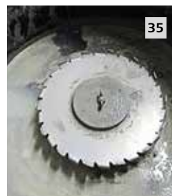
Der Einsatz einer Dispersions-scheibe ist zwingend nötig.
