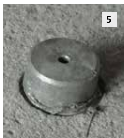
5 Geklebter Haftzugsstempel, vorgebohrt
