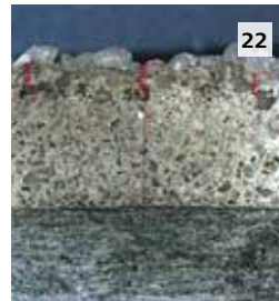
Eindringtiefe von Sand nach 10 Min. Quarzsand ist ausreichend eingebunden
