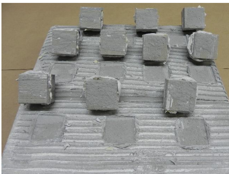
Svolgimento di un test applicativo per valutare l'idoneità di un rivestimento per facciate esterne.
