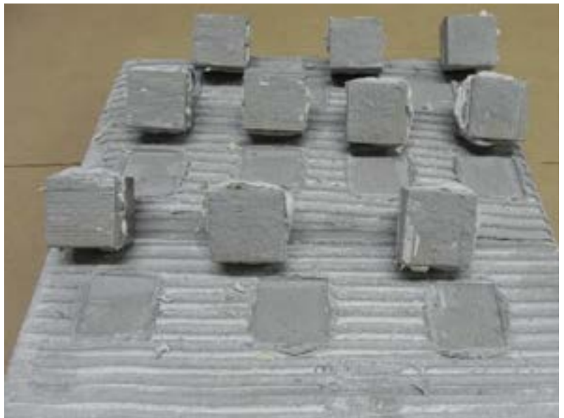
Réalisation d'un test d'application pour juger de l'adéquation d'un revêtement dur de façade.
