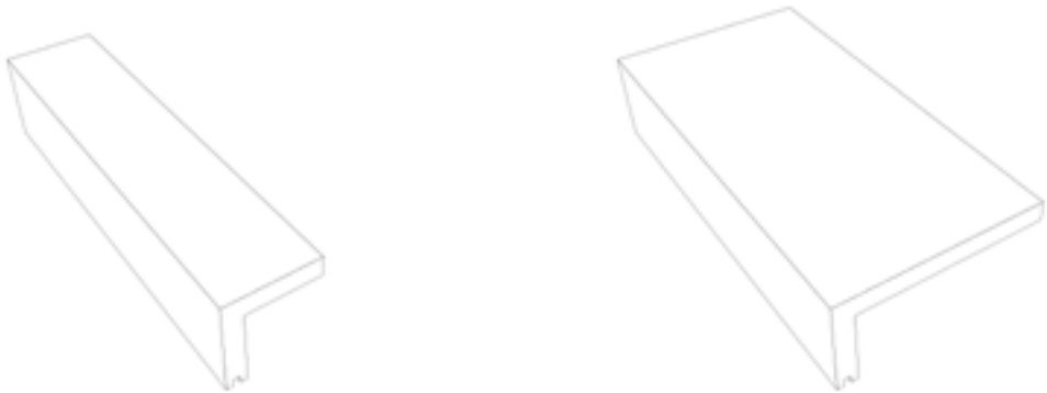
Zone du linteau : plaquette pour angle de linteau réalisable sur demande
