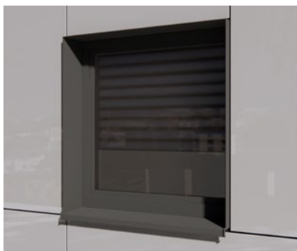
Variante 1 châssis métallique en porte à faux
