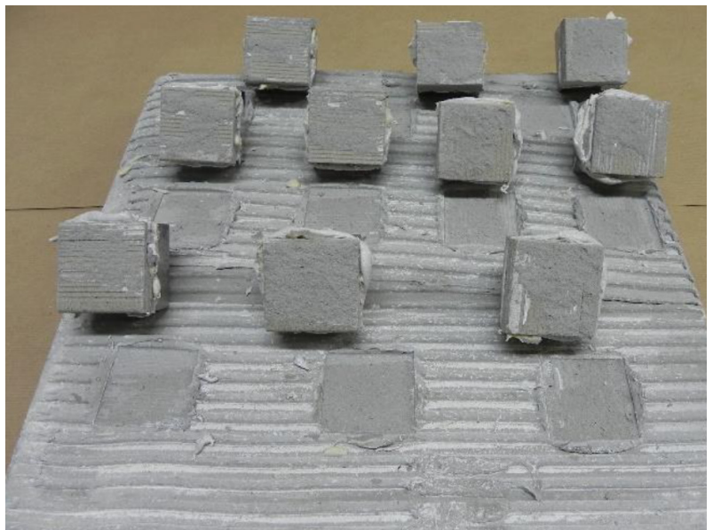
Durchführung eines Anwendungstests zur Beurteilung der Eignung einer externen Fassadenbekleidung.
